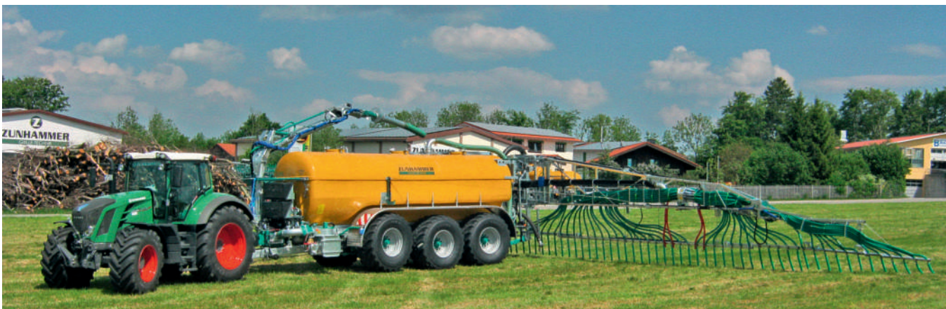
SKE 24000PU TRIDEM z rozdzielnikiem o szerokości roboczej 27 m z węzami wleczonymi
