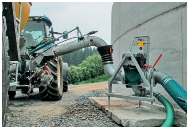
Zespół lejów ze sterowaniem radiowym przy napełnianiu ze zbiornika naziemnego
