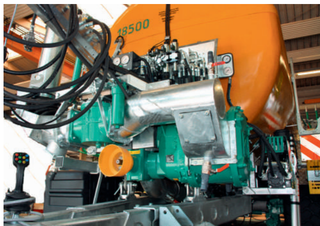
Pompa ECO w zabudowie poprzecznej z lewej strony
