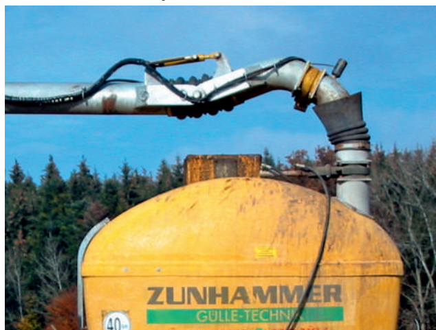
Ekstremalne pochylenie elastycznego leja przy napełnianiu
