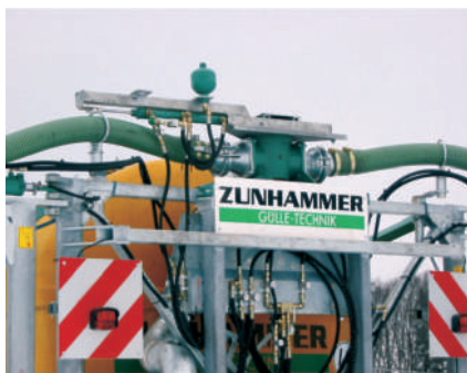
Załączanie częściowej szerokości roboczej z lewej / z prawej strony
