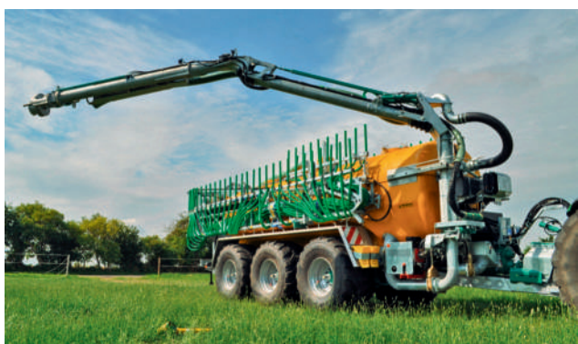
TRIDEM z wysięgnikiem zasysającym DINO
