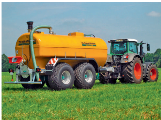
Przyczepa asenizacyjna STS 18000 kombi z turbiną wyładowczą
