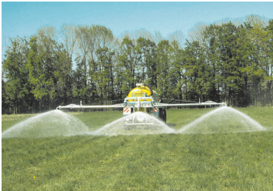
Rozdzielacz z belką wyposażoną w dyszę podczas pracy
