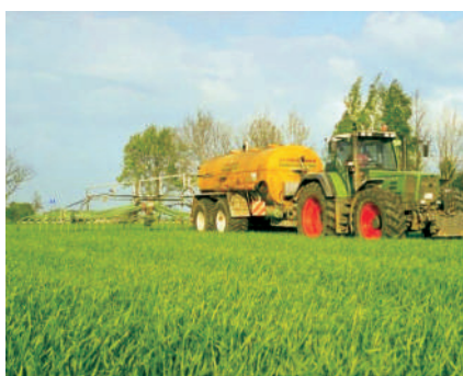
Rozdzielacz z węzami wleczonymi przy pracy w zbożu
