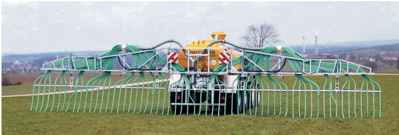
Węże wleczone Ex30+30 na szerokości roboczej 18 m
