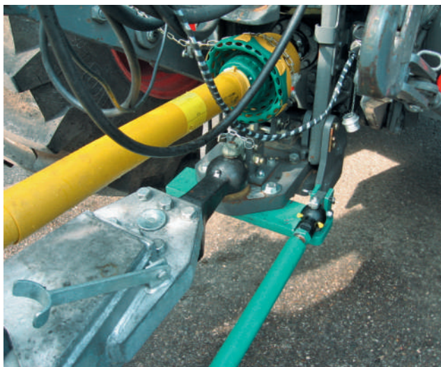
Hydrauliczne kierowanie wymuszone
