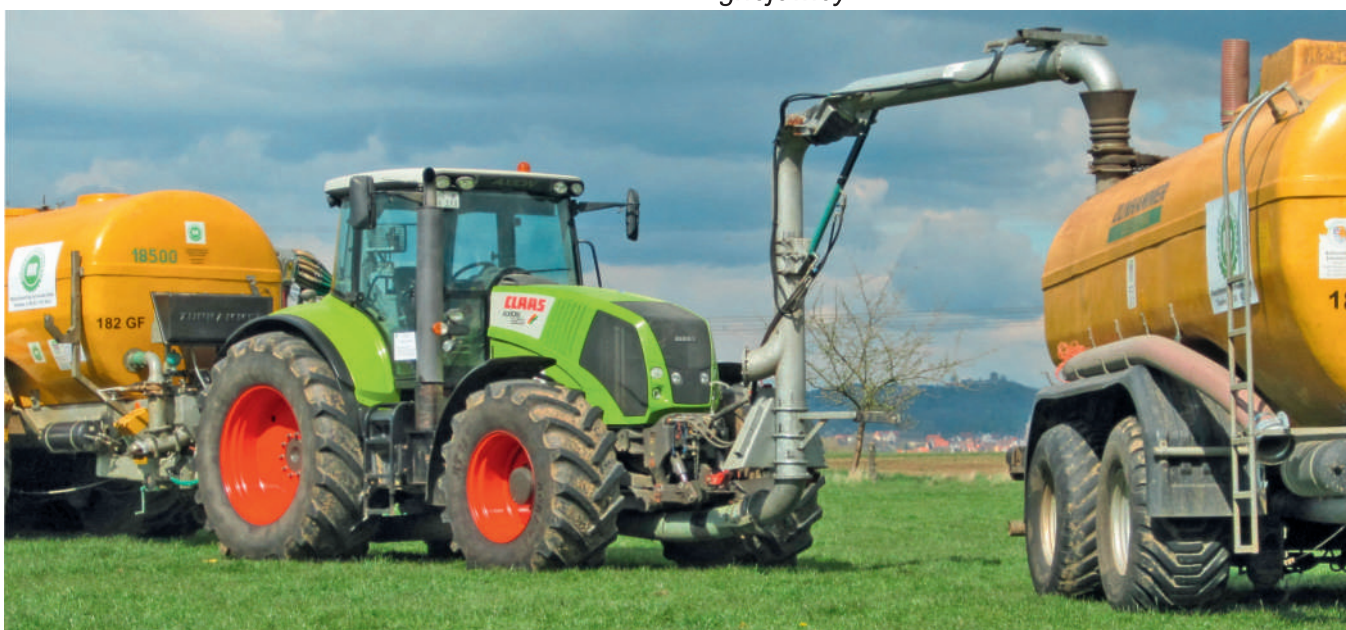
Napełnianie z użyciem zespołu dokującego z przodu ciągnika
