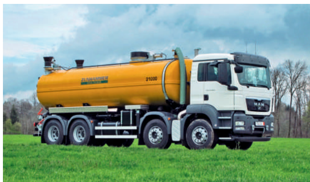
Zabudowa na samochodzie ciężarowym o pojemności 21 m 3
