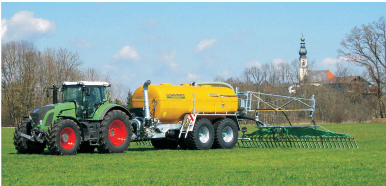
SKE 16500 ECO-DUO z rozdzielaczem Farmlandfix o szerokości 18 m
