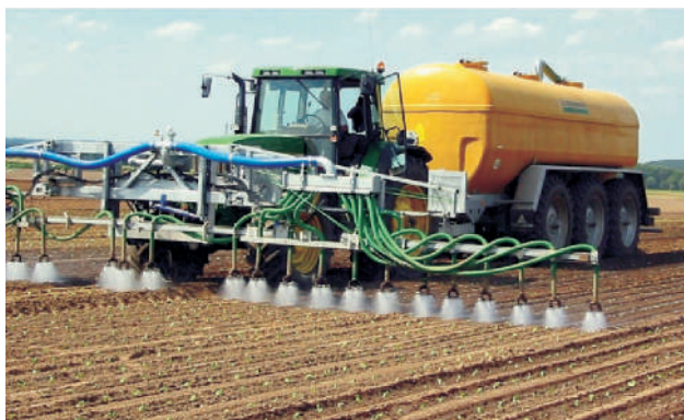
Specjalna przyczepa ze zbiornikiem wody SK27PU i belką rozdzielacza do upraw warzywnych
