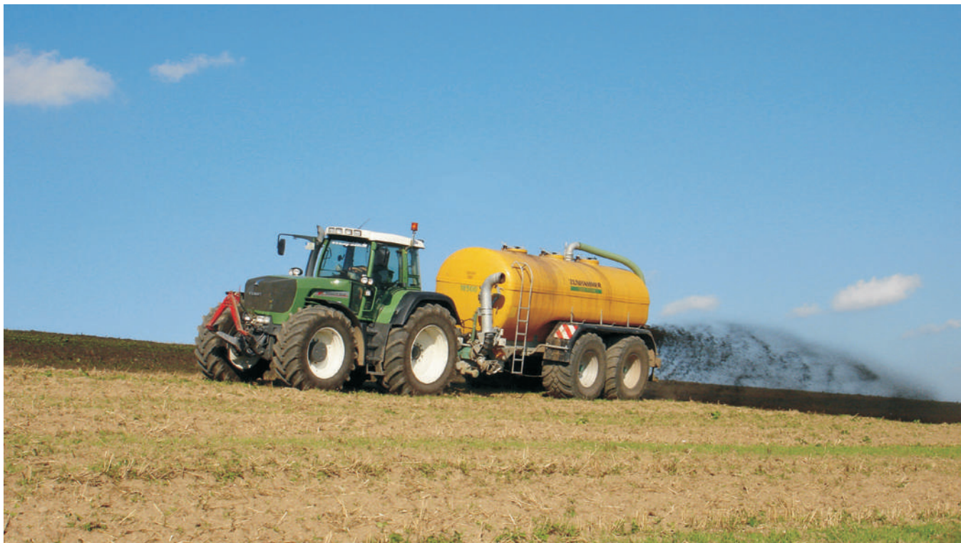
SKE 18500 z rozdzielaczem z głowicą rozpryskującą
