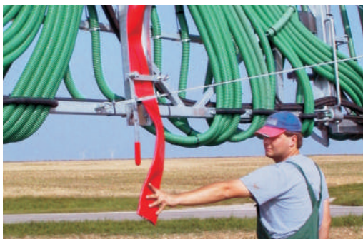
Rozdzielacz Exacut z łapaczem kamieni
