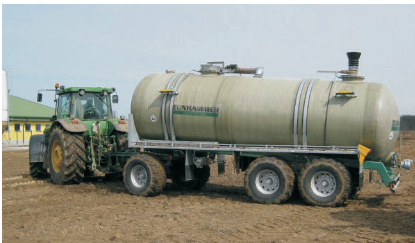
K21T – przyczepa asenizacyjna z instalacją pompową
