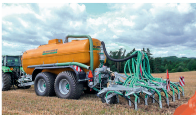
Gruber wibracyjny do gnojowicy o szerokości roboczej 4,5 m
