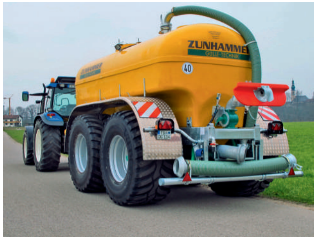
MKE 14000 ECO z rozdzielaczem z głowicą rozpryskującą
