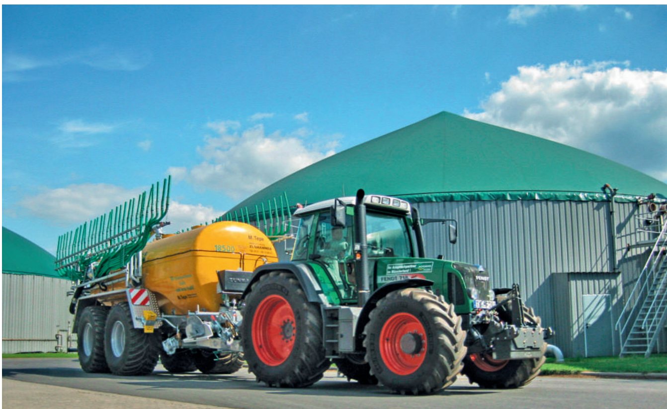
SK18500PU z rozdzielaczem z węzami wleczonymi o szerokości roboczej 15 m w położeniu transportowym
