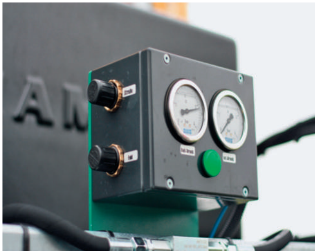
Instalacja regulacji ciśnienia w oponach
