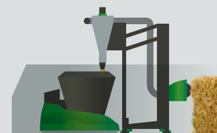
BEZPOŚREDNIE NAPEŁNIANIE SHUTTLE ECO Z SYSTEMEM „LIFT” W SILOSIE PRZEJAZDOWYM
