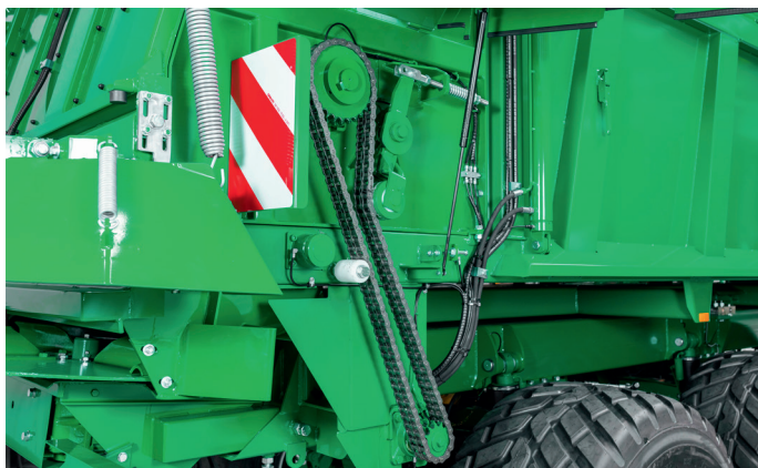
Walec frezujący napędzany jest przez łańcuch rołkowy typu duplex. Przy zamkniętej skrzynce ochronnej można sprawdzić i dokręcić napinacz łańcucha.
