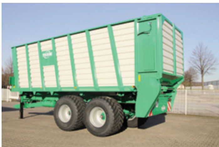
Samowyladowcze przyczepy do zielonki jako nadwozia wymienne do podwozi typu tandem, o pojemności 43 m 3 i 60 m 3 w przypadku podwozi typu tridem.
