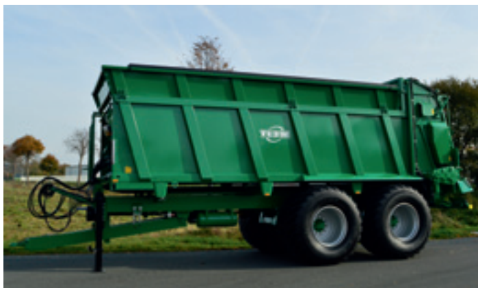
HS 220 z wymiennym, całościowo spawanym nadwoziem stalowym o wysokości 1400 mm.
